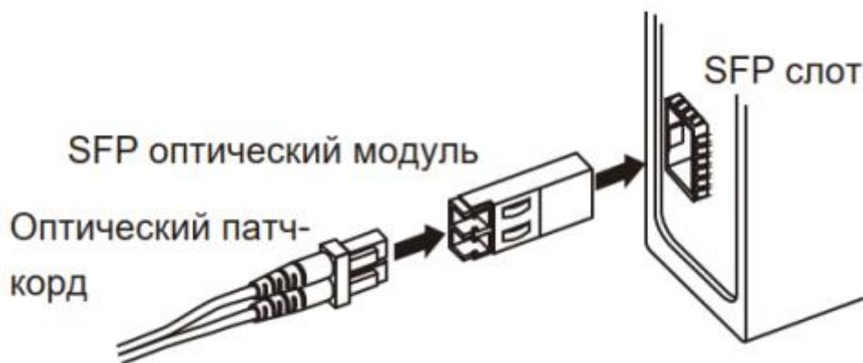
Рисунок 3 – Установка модуля SFP/SFP+
