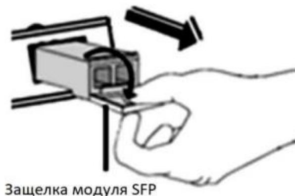
Рисунок 4 – Извлечение модуля SFP/SFP+
