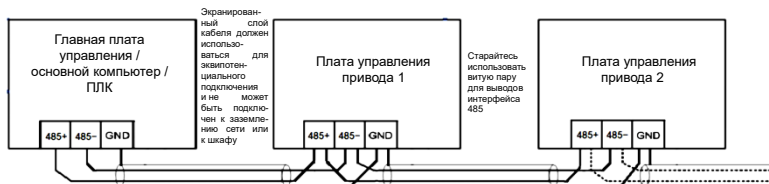
Рис. 3-32. Схема подключения интерфейса RS485
