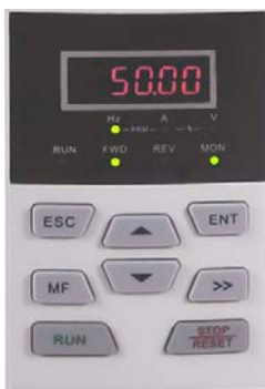
Рис. 4-2. Режим отображения параметров останова (отображение заданной частоты – 50,00 Гц)
