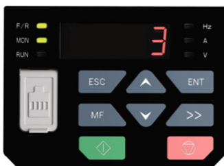
Рис. 4-10. Второй уровень отображения параметра («3» – это значение параметра b0-00)
