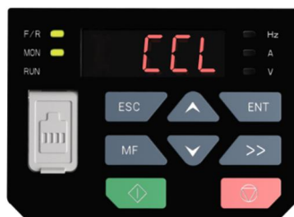
Рис. 4-4. Режим отображения неисправности или тревоги (CCL: ошибка срабатывания контактора)
