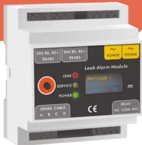
**Модуль позиционирования SYSG5002** может обнаруживать утечку воды, кислот и щелочей, масла и других жидкостей и позволяет подключить чувствительный кабель на расстояние до 1500 метров. При обнаружении протечки жидкости место утечки отображается на ЖК-экране и срабатывает реле сигнала тревоги.
