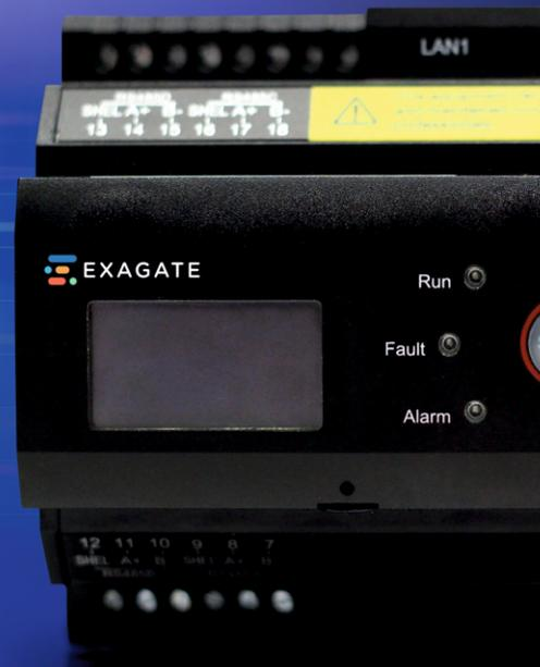
Системы мониторинга аккумуляторов (BMS) необходимы для поддержания оптимальной производительности и срока службы аккумуляторов, используемых в различных приложениях, включая системы ИБП, центры обработки данных, базовые станции связи и накопители солнечной энергии. Эти системы обладают возможностями интеллектуального мониторинга для отслеживания показателей работоспособности, состояния и производительности отдельных аккумуляторов и групп аккумуляторов.
