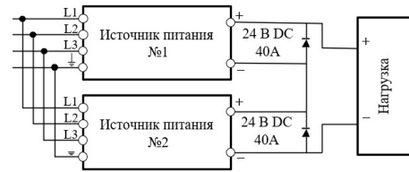
Последовательное подключение двух источников питания
