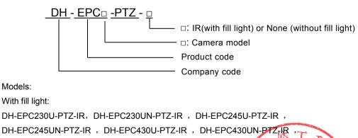
DH-EPC240V-PTZ-IR , DH-EPC240VN-PTZ-IR Without fill light : DH-EPC230U-PTZ, DH-EPC230UN-PTZ, DH-EPC245U-PTZ, DH-EPC245UN-PTZ DH-EPC430U-PTZ, DH-EPC430UN-PTZ, DH-EPC240V-PTZ, DH-EPC240VN-PTZ Ingress protection level: IP68(1.2m/45min) Ex marking:  $\begin{array}{c} \\ \end{array}$  2614  $\begin{array}{c} \\ \end{array}$  II2G Ex db op is IIC T6 Gb 300 1000051814 Camera type: HD network Camera
