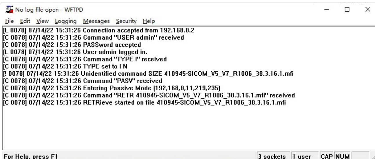
Рисунок 33 Нормальная связь между FTP-сервером и коммутатором
