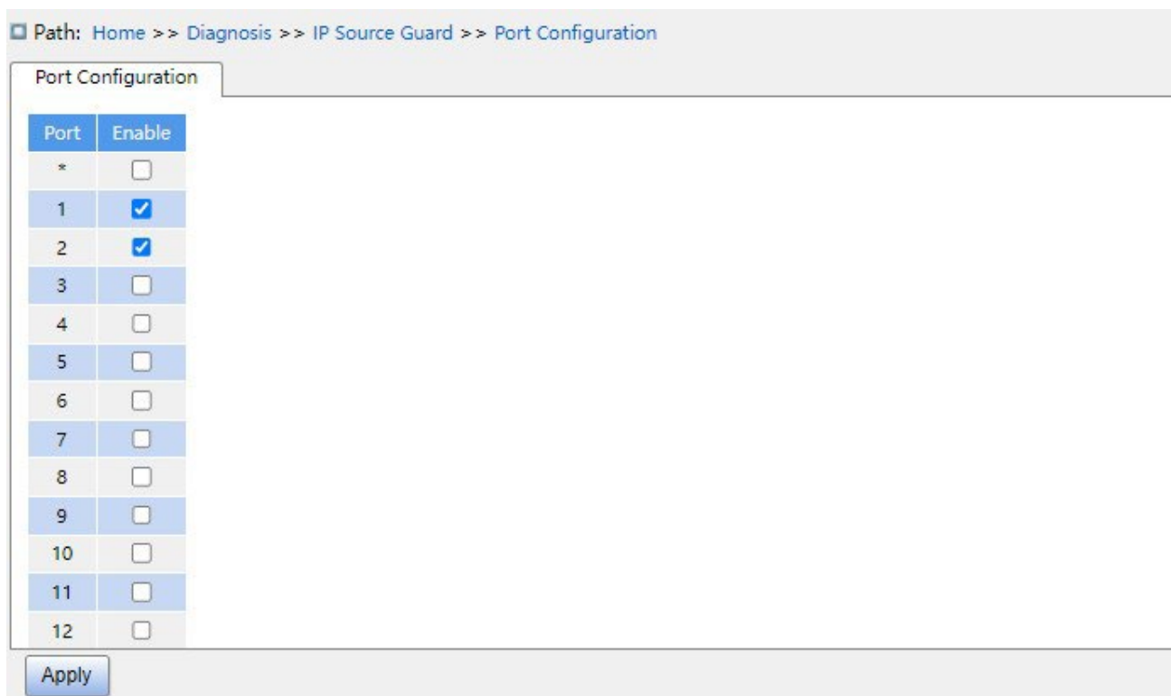
Рисунок 246 Настройка IP Source Guard для порта
