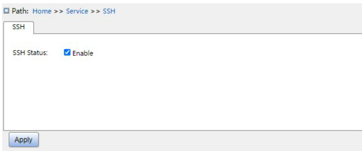
Рисунок 60 Включение протокола SSH
