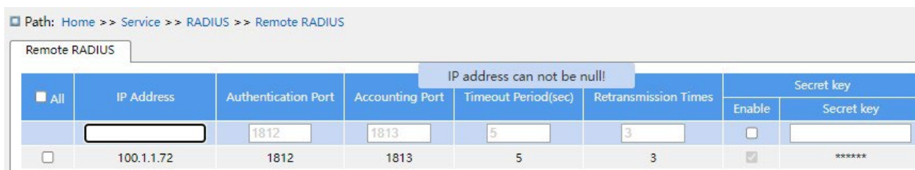
Рисунок 69 Настройка сервера RADIUS
