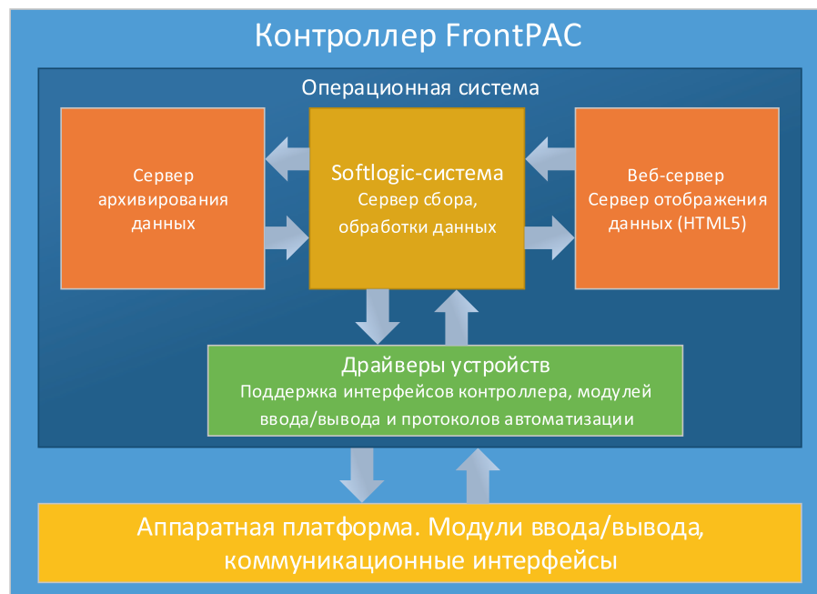
Рис. 2. Структура контроллера FrontPAC
