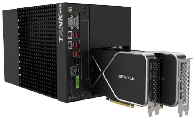
Многослотовый встраиваемый компьютер с возможностью установки 2-х RTX3090
