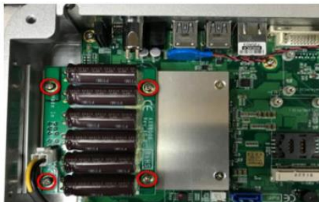
Внутренний PoE модуль до 120Вт
