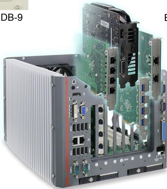
Многослотовый встраиваемый компьютер с 7 слотами PCIe
