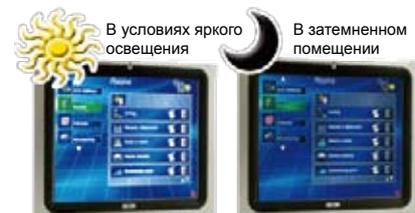
Автоматическая регулировка яркости в зависимости от внешней освещенности
