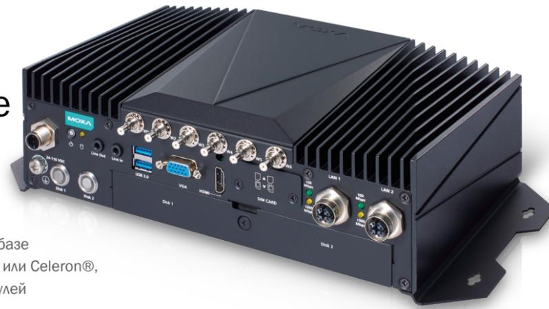
Железнодорожные компьютеры серии V2406C построены на базе высокопроизводительных процессоров Intel® Core™ i7/i5/i3 или Celeron®, имеют возможности для расширения памяти и установки модулей беспроводной связи, все это в компактном корпусе.
