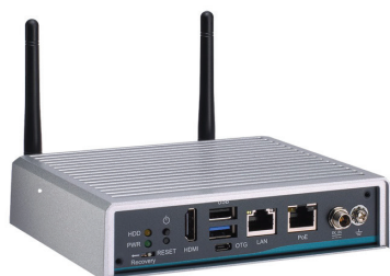
Axiomtek AIE100-903-FL(NX) Промышленный безвентиляторный компьютер для задач видеоаналитики
