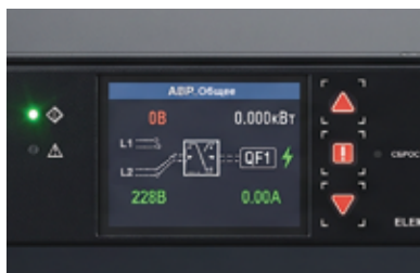
4. Локальное наблюдение — параметры работы устройства выводятся на дисплей
